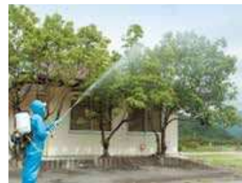
背負動噴低圧(0.5MPa)時の直射噴霧例
